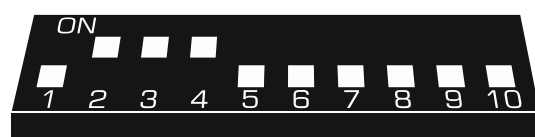
Abb. 12. Einstellung der DIP-Schalter in Erweiterungsmodulen, falls sie als CA-64 Ei / CA-64 EPSi identifiziert werden sollen.
