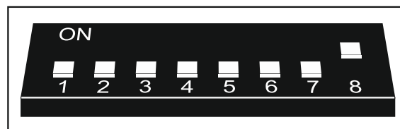
Abb. 9. Einstellung der DIP-Schalter im Modul ACU-120 / ACU-270.
