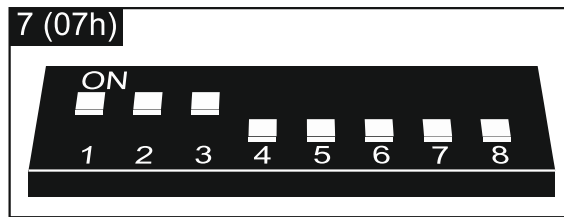
Abb. 5. Adresseinstellung im Erweiterungsmodul INT-RX-S / INT-RX.
