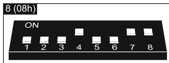
Abb. 10. Einstellung der DIP-Schalter im Modul ACU-100.
