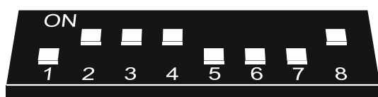
Abb. 12. Einstellung der DIP-Schalter in Erweiterungsmodulen, falls sie als CA-64 Ei / CA-64 EPSi identifiziert werden sollen.
