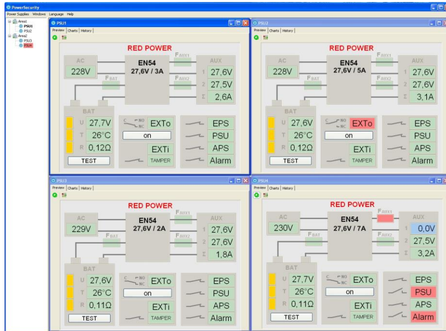
Abb. 21. Hauptpanel des Programms „Power security“.
