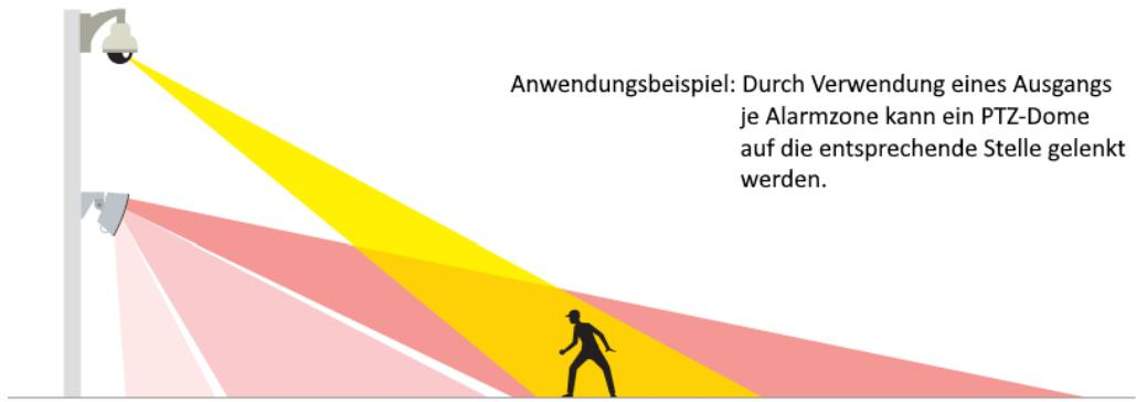
Anwendungsbeispiel: Durch Verwendung eines Ausgangs je Alarmzone kann ein PTZ-Dome auf die entsprechende Stelle gelenkt werden.
