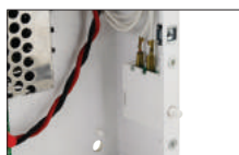
Manipulationsschutz - Öffnen des Gehäuses - 1 St.
