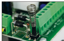
Manipulationsschutz - Öffnen des Gehäuses - 1 St.
