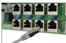
RJ45-Stecker Ausgang / Eingang
