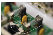
Möglichkeit der Wahl der Sicherung mit Hilfe eines Jumper: Schmelzsicherung / PTC
