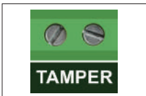
Tamper - Anschluss für Mikroschalter für Anti-Sabotage-Schutz
