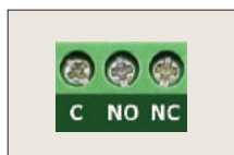
Technische Ausgänge typu relais: FAC - Ausfall der AC-Versorgung
