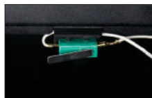
Manipulationsschutz - Öffnen des Gehäuses - 1 St.
