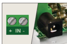
Buchse für die Versorgung - Schraubenverbindung - Steckdose DC 5,5/2,1
