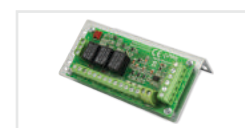
MPSB12/24/48 Service-Ausgang-Modul vom Typ OC und Relaisausgänge
