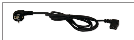
PSD13 Kabel 230VAC 3x 0.75 mm², 2 m, CEE 7/7 (EF), gewinkelter Anschlußstecker IEC C13
