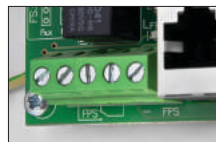
Technische Ausgänge vom Typ OC und Relais FPS - Sicherungsstörung
