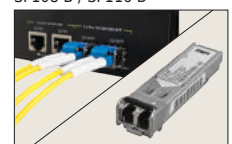
SFP UPLINK Ports Es können SFP- Lichtwellenleiter-Module eingesetzt werden
