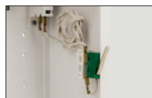
Manipulationsschutz - Öffnen des Gehäuses - 1 St.
