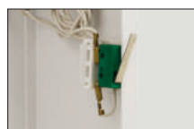
Manipulationsschutz - Öffnen des Gehäuses - 1 St.
