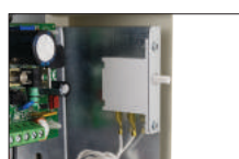
Manipulationsschutz - Öffnen des Gehäuses - 1 St.
