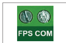
Technischer Ausgang OC Typ FPS - Sicherungsstörung
