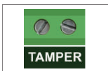
Tamper - Anschluss für Mikroschalter für Anti-Sabotage-Schutz
