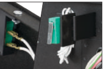
Manipulationsschutz gegen Öffnen des Gehäuses Manipulationsschutz gegen Öffnen des Rangierfeldes
