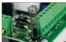
Manipulationsschutz - Öffnen des Gehäuses - 1 St.
