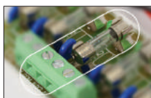
Kamera- Ausgänge - Sicherungen Schmelzsicherung 8×1,0A / 16×1,0A
