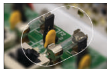
Möglichkeit der Wahl der Sicherung mit Hilfe eines Jumper: Schmelzsicherung / PTC
