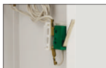
Manipulationsschutz - Öffnen des Gehäuses - 1 St.
