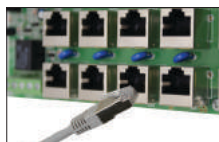
RJ45 Anschlüsse - Eingang / Ausgang
