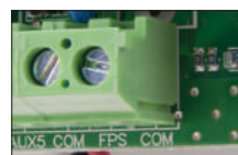
Technischer Ausgang OC Typ FPS - Sicherungsstörung
