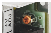
Einstellpotentiometer der Ausgangsspannung
