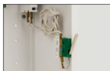
Manipulationsschutz - Öffnen des Gehäuses - 1 St.
