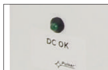
Optische Signalisierung mit LED
