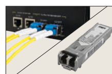
SFP UPLINK Ports Es können SFP- Lichtwellenleiter-Module eingesetzt werden
