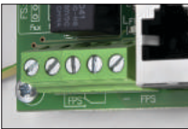
Technische Ausgänge vom Typ OC und Relais FPS - Sicherungsstörung
